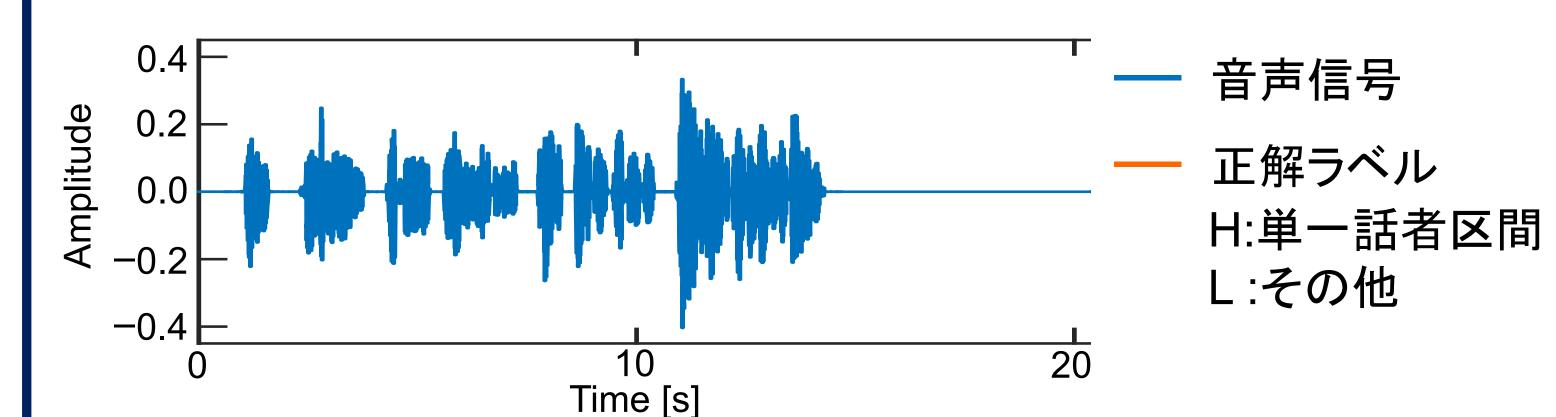
深層ニューラルネットワークに入力するデータの前処理 - FFT長ごとに振幅スペクトログラムの作成を行う 時間領域 時間周波数領域 混合音声 離散 正解ラベル フーリエ 変換 1:単一話者発話区間 正解ラベル スライド長 振幅情報 0:その他 (窓長の半分) のみ取得 1 0 ' FFT長(窓長)
